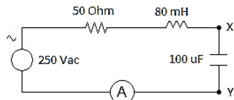
A partir do circuito equivalente resultante, o profissional deve calcular o valor total da corrente que passa pelo medidor, assim como o valor do módulo da tensão entre os terminais X e Y. Dessa forma, determine seus valores dissertando os procedimentos de cálculo.
