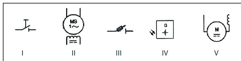
Quais símbolos representam, respectivamente, motor série de corrente contínua, gerador fotovoltaico e interruptor seccionador?
