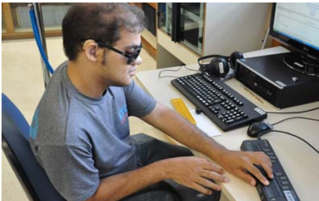
O advogado Moysés Joaquim da Silva, que nasceu cego, usa o dispositivo Linha Braille, um hardware disponível na biblioteca do TRF2, que traduz para o sistema Braille a informação que está na tela do computador, permitindo a leitura tátil
